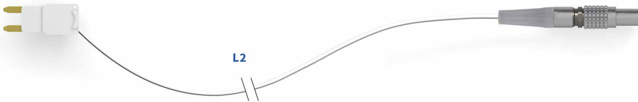
FK1/MINI-Sicherungssensor Slim für Strommessungen im Sicherungskasten. Integrierter Präzisions-Shunt und interne Schmelzsicherung sowie kompakte Abmessungen und dünnes, flexibles Anschlusskabel. Automatische Probe-Identifikation.
