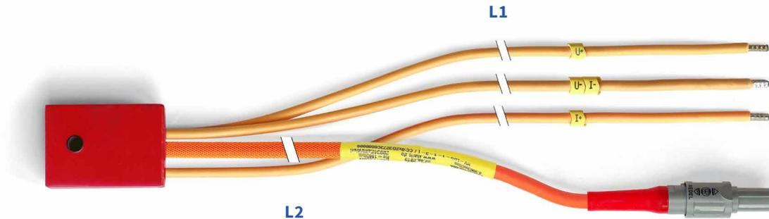
Für Shunt-basierte Messungen von Ruhe-, Betriebs- und Spitzenströmen im Bereich von nA bis A sowie von Spannungen in Bordnetzen in Fahrzeugen oder Prüfständen. Automatische Probe-Erkennung.
