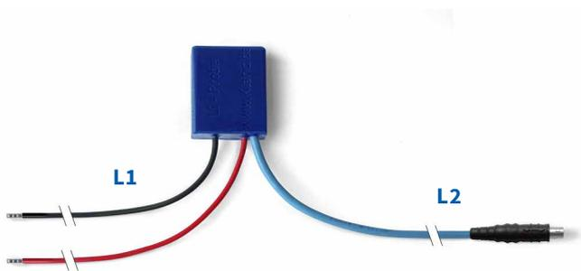
LI-Probe zur Messung von Ruhe, Betriebs- und Spitzenströmen im Labor oder am Prüfstand, in 12 V, 24 V oder 48 V Bordnetzen. Automatische Probe-Erkennung.
